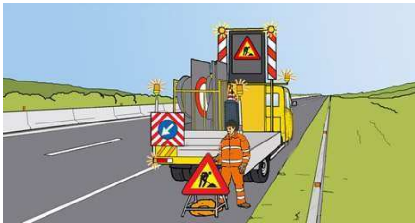
Figura 18 – Chiusura della corsia di emergenza: installazione del cartello di lavori in corso
