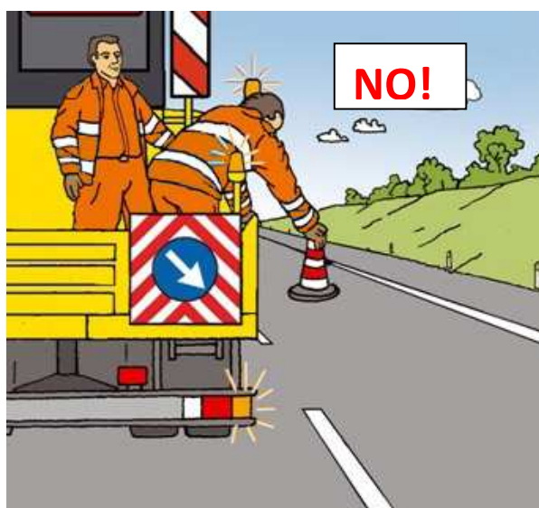
Figura 36 – Posizionamento dei coni o dei delineatori flessibili: comportamento scorretto
